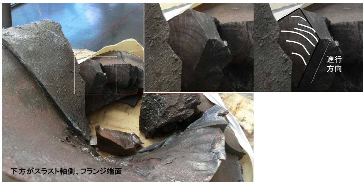
図9 中間軸折損部 (フランジ側)
