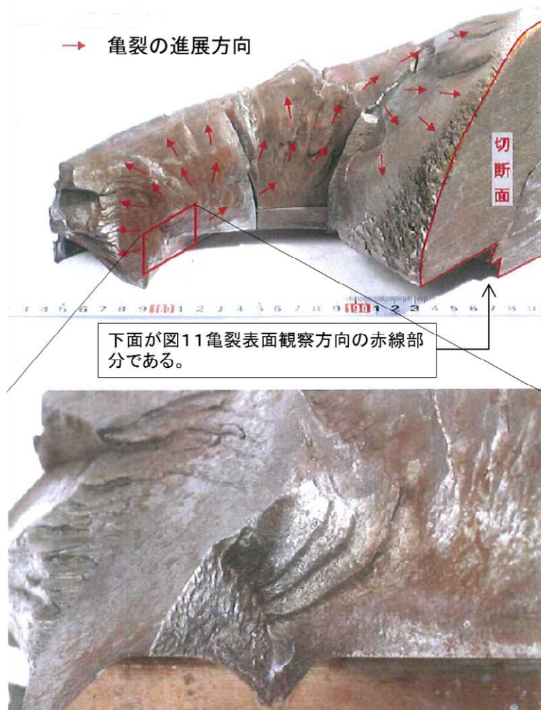
図12 亀裂表面状態
