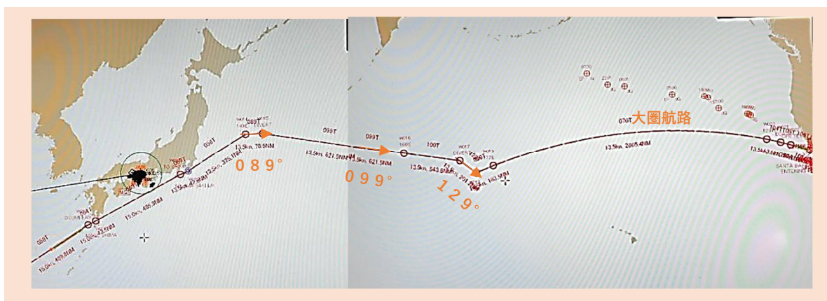
図5 ECDISで表示した変更3計画の予定進路
