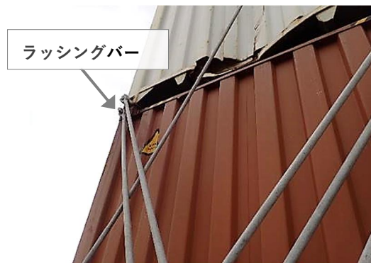
写真18 ラッシングバーの状態
