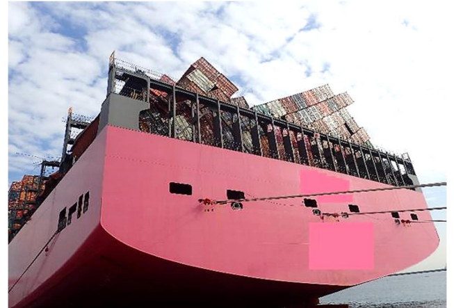
写真9 船尾部コンテナの倒壊状況
