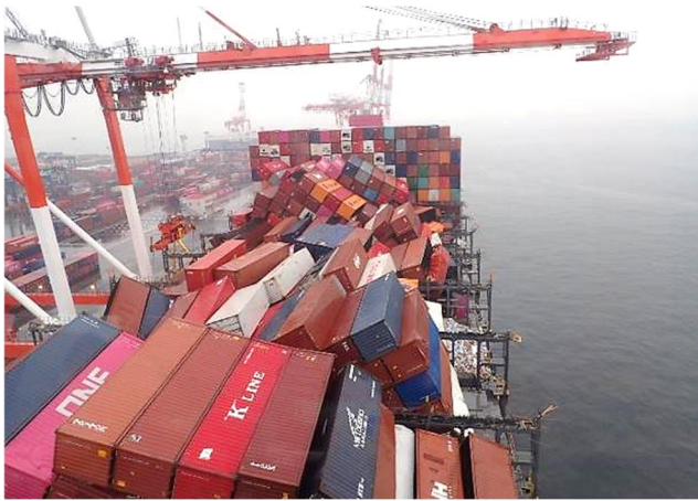
写真6 上甲板上コンテナの倒壊状況
