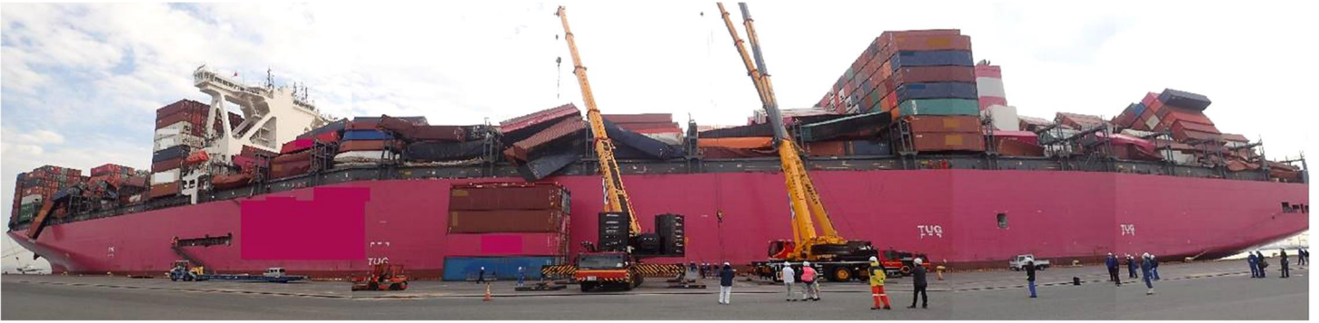
写真5 本船の左舷側から見たコンテナが倒壊した状況
