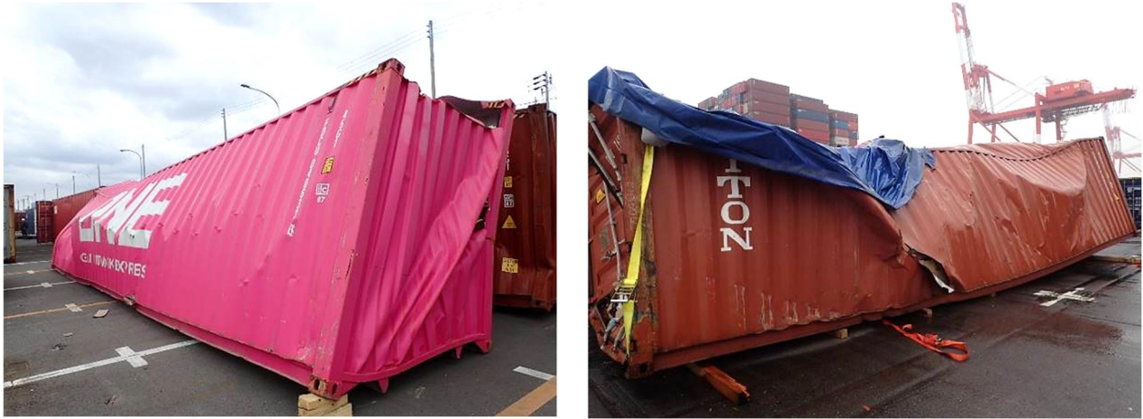
写真10 コンテナの圧損状況
