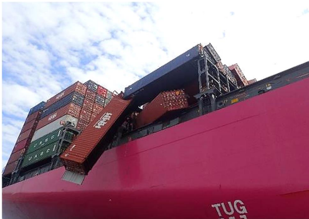
写真8 落下寸前のコンテナの状況
