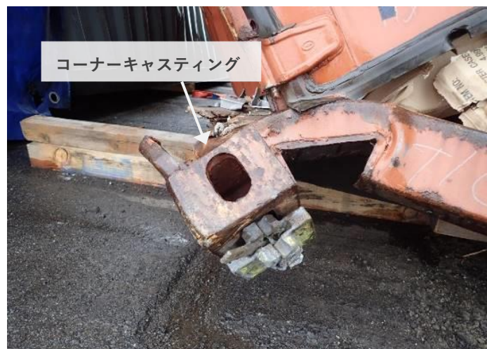
写真11 コンテナ底部材の変形状況
