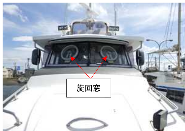
写真6 B船の僚船の操舵室前面の窓ガラス
