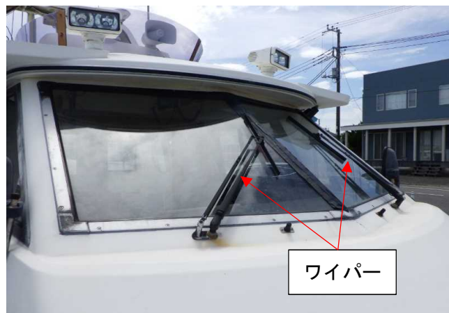
写真5 B船の操舵室前面の窓ガラス
