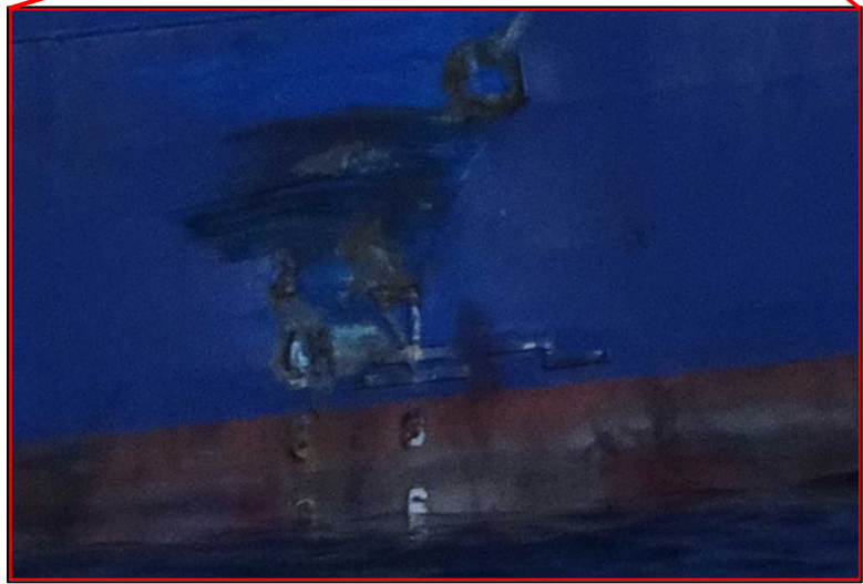
写真1 A船及び損傷状況
