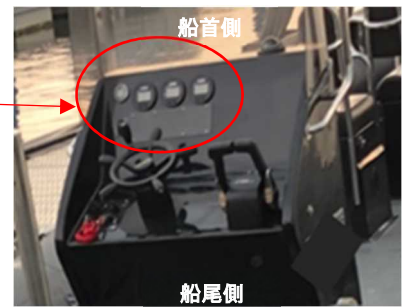
新規計器類の取付け後
