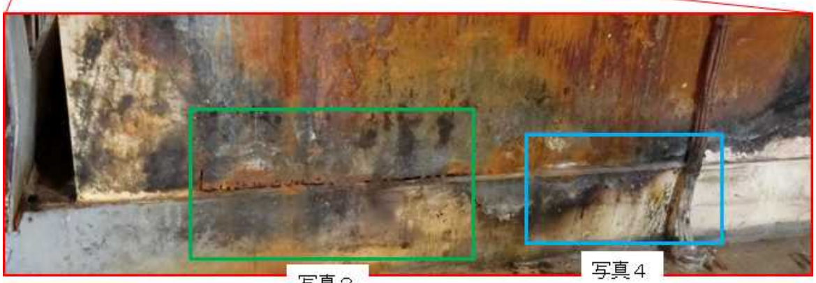
図3 US室右舷側の本件壁面付近の焼損状況
