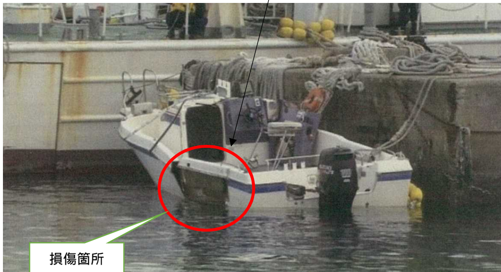
写真5 B船の損傷状況（左舷中央部）
