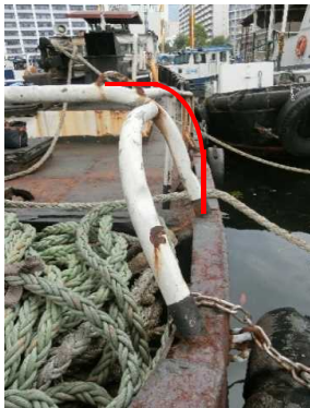
(4) 右舷側船尾部のハンドレール が左舷方に曲損
