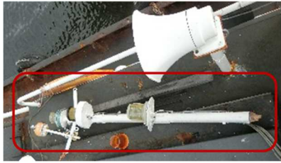
(1)マストの折損、落下の状況
