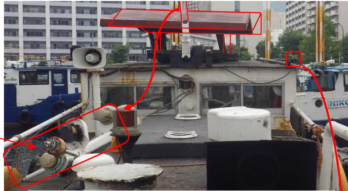
マスト、右舷灯及び操舵室等の損傷状況 (船尾側より撮影)
