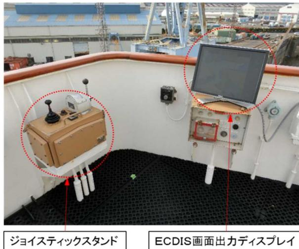
図7 入出港の操船時における左舷ウイングのジョイスティックスタンド及びECDIS画面出力ディスプレイの設置状況 (再現写真)
