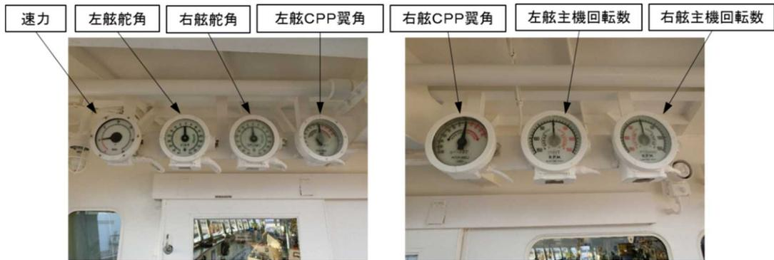
図6 左舷ウイングの船外表示器
