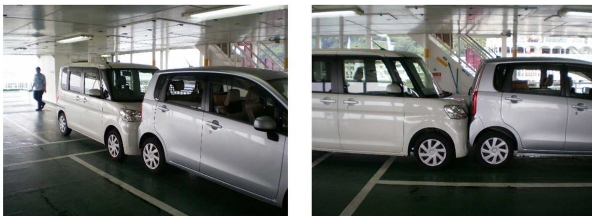
図4 本船に積載されていた車両の接触状況
