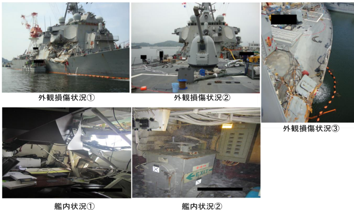
図5 B船の損傷状況（アメリカ合衆国沿岸警備隊より提供）
