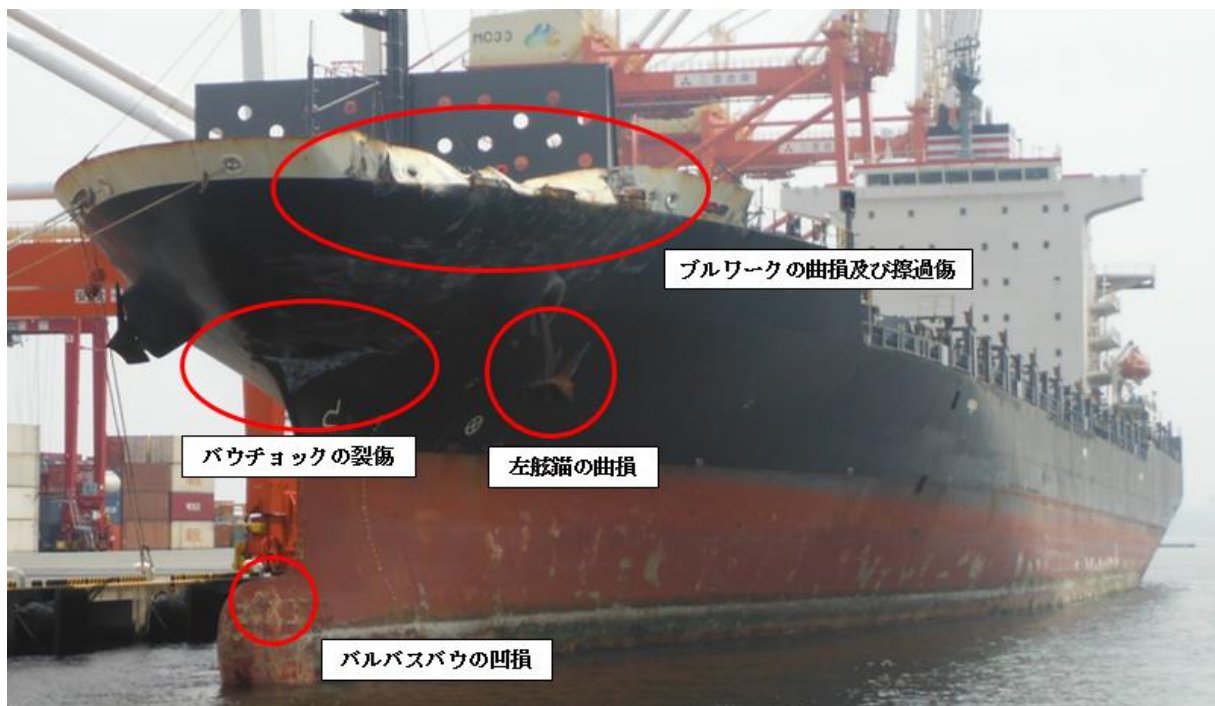
図1 A船の損傷状況（船首部）
