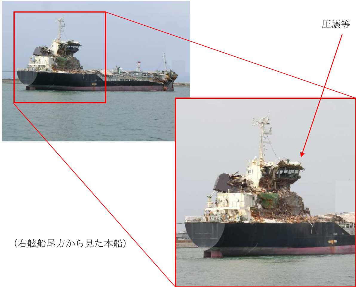
図 1 - 2 本船の損傷状況
