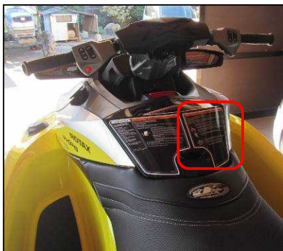
写真9 警告ラベルの位置
