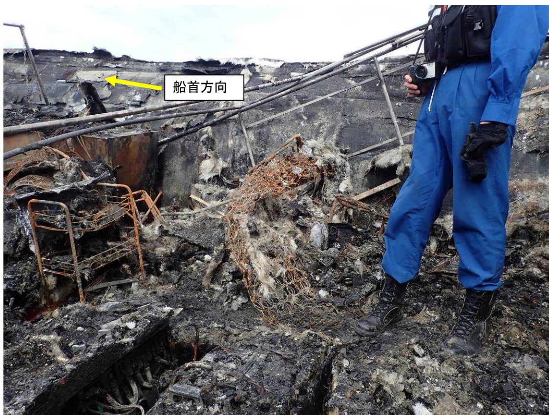
写真3 焼失した本件船室
