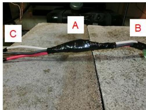
写真5 2 熱電対の設置箇所
