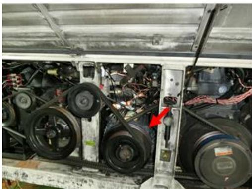
写真6 冷凍機内のモータ
