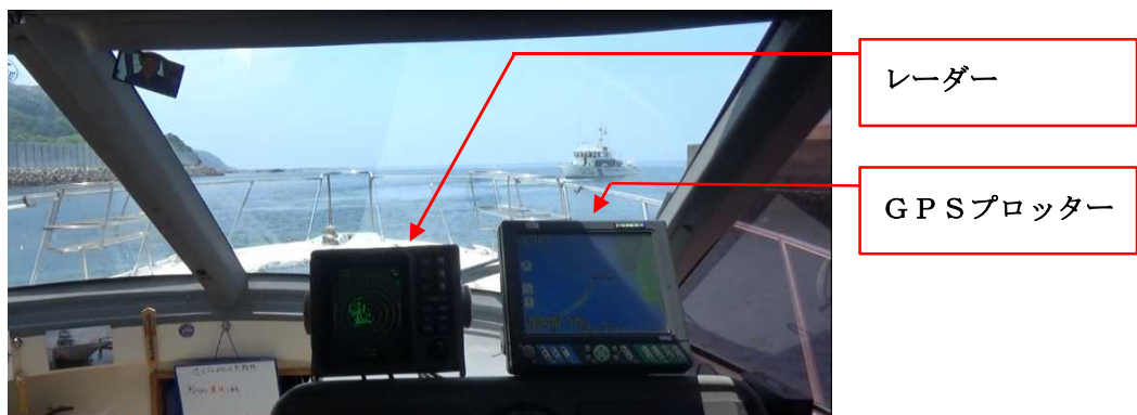
図5 操縦席前部の航海計器配置及び操縦席からの前方視界
