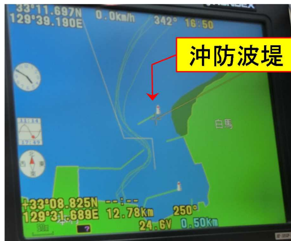
図8 過去4航海分の航跡が表示されたGPSプロッター
