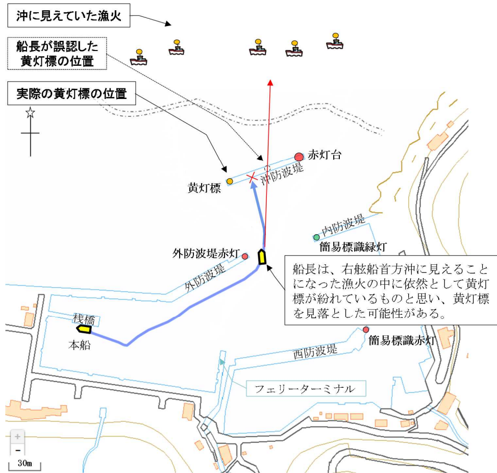
図15 本船の船位及び針路による黄灯標の位置の見え方②
