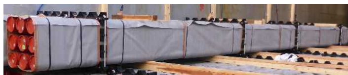
写真2.1-1 9本の結束パイプ
