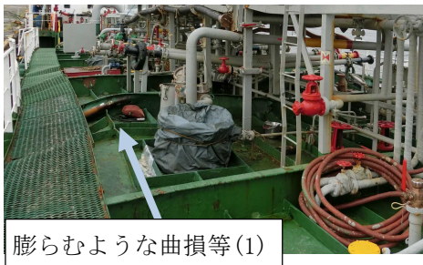
(右舷側の貨物タンク頂部の損傷状況)
