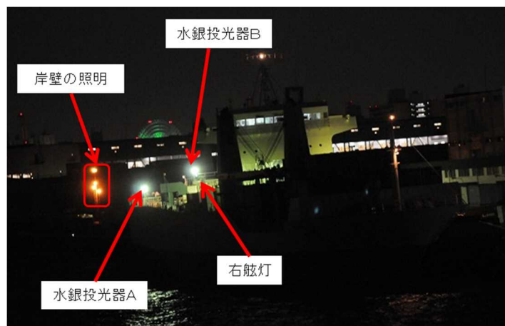
写真 2.8-8 水銀投光器 A、水銀投光器 B 及び右舷灯 (A 船の右舷前方約 5^{\circ} ~ 10^{\circ} 内) (望遠レンズを使用して撮影)
