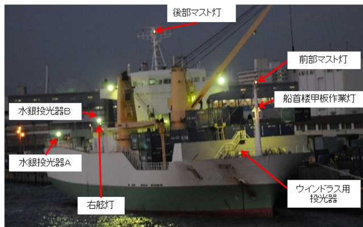
写真2.8-6 A船の法定灯火及び照明 (A船の右舷前方約5° ~ 10° 内) (望遠レンズを使用して撮影)
