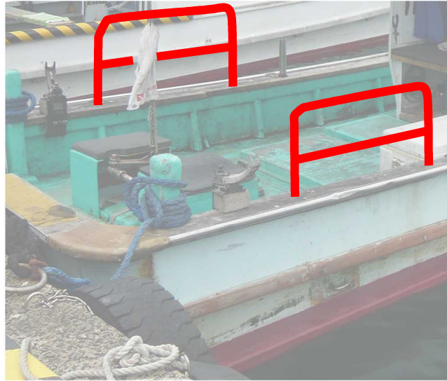
図3 落水防止柵の設置イメージ
