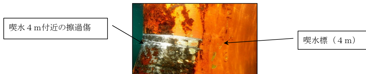
写真1 船首部の擦過傷
