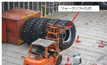
写真6 フォークリフトによる転倒防止1
