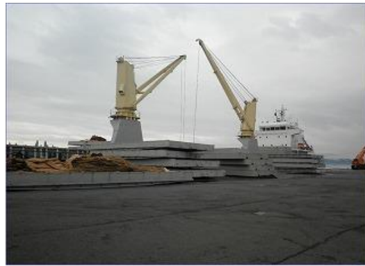
写真2.1-1 2 本船及び岸壁に移動させた上甲板用ハッチカバー
