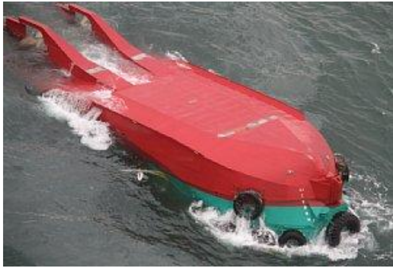
写真1 本船転覆後の状況
