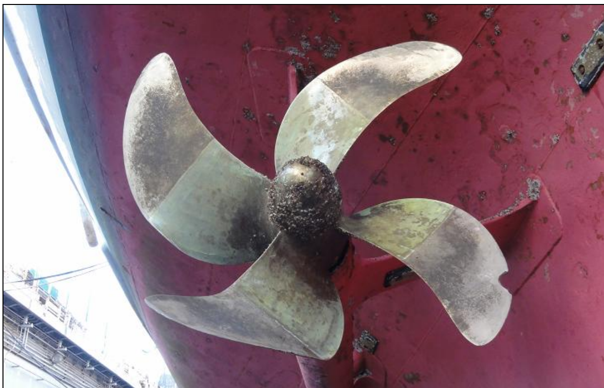
写真8 左舷側推進器のプロペラ翼の欠損及び擦過傷
