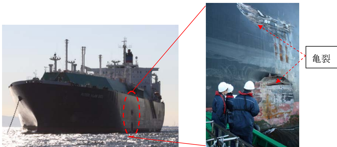
写真2.3-1 A船の損傷状況
