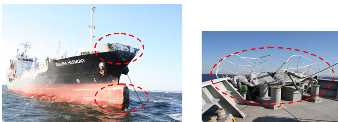
写真2.3-2 B船の損傷状況
