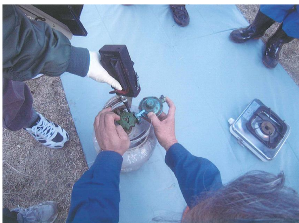
写真 2.2.2-2 本件容器と本件調整器 接続部の漏えい確認 (大阪市消防局撮影)
