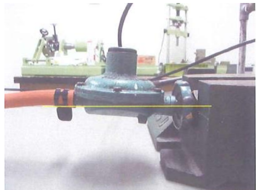
写真 2.10.2-2 本件調整器の変形 (L I A撮影)
