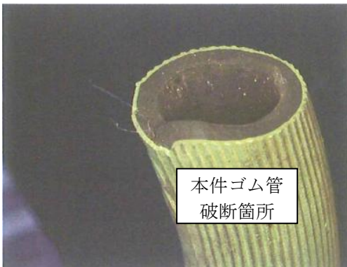
写真 2.10.3-7 本件ゴム管破断部 (L I A 撮影)
