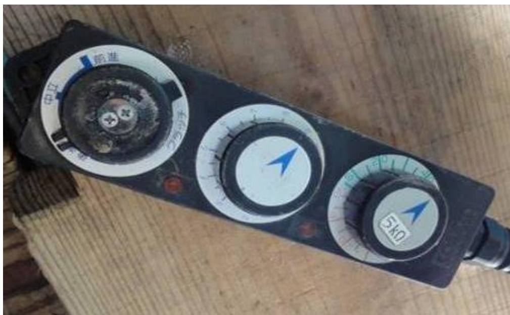
写真2-7 リモコン (左のダイヤルから、クラッチ、増減速、舵)
