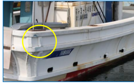
『B船の右舷船尾の擦過痕』
