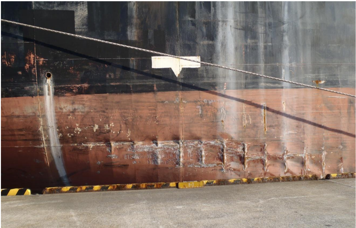
写真2 本船の右舷後部の損傷
