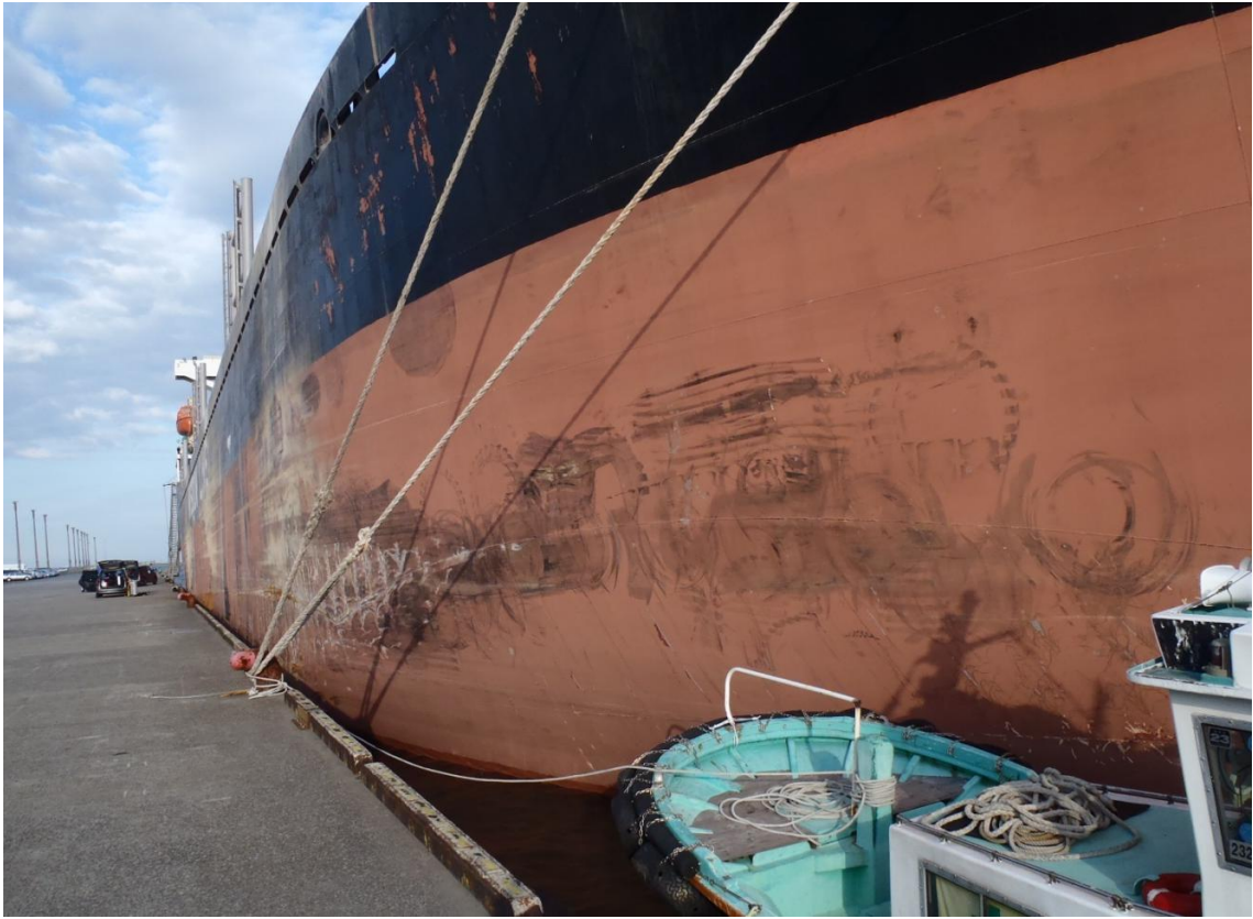
写真1 本船の右舷前部の損傷
