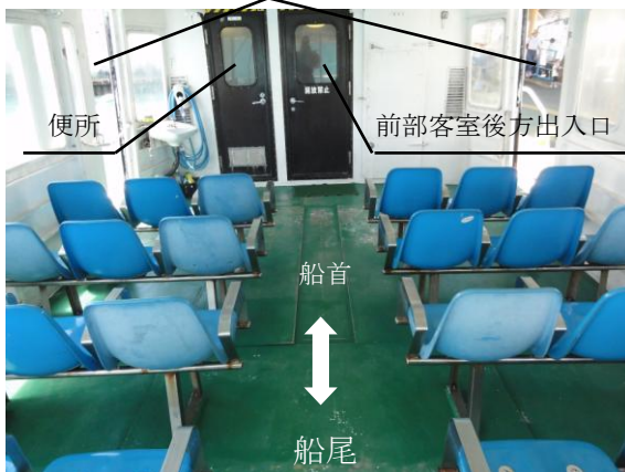
写真 2.5-13 後部客室の座席の状況
