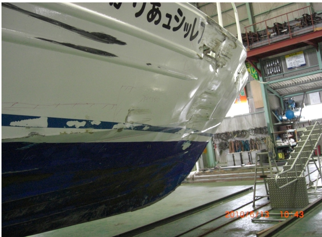
写真4 右舷船首部の損傷状況
