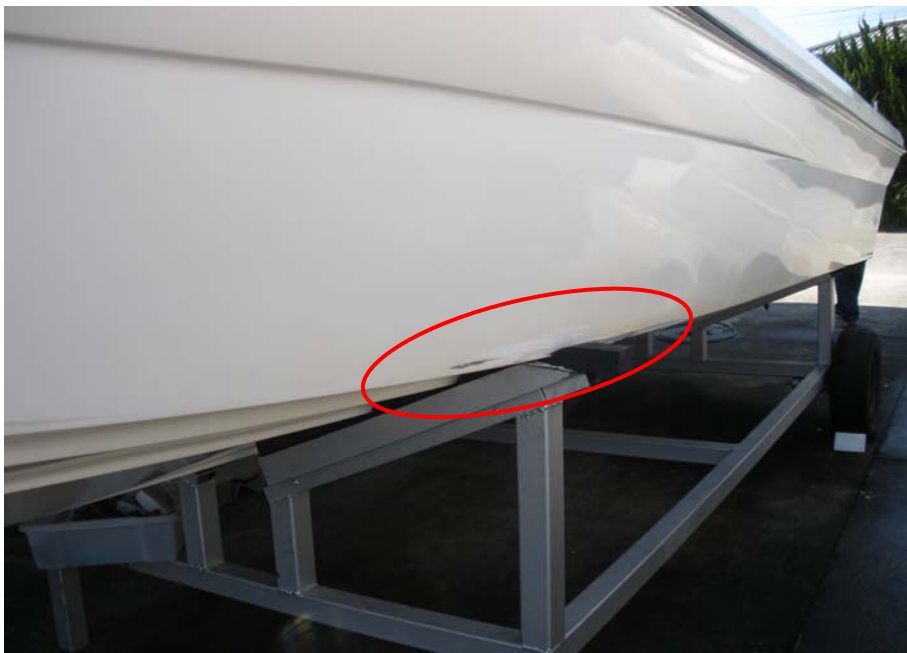
写真2 本船の損傷状況（左舷中央下部）
