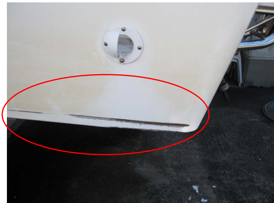
写真3 本船の損傷状況（左舷船尾下部）
