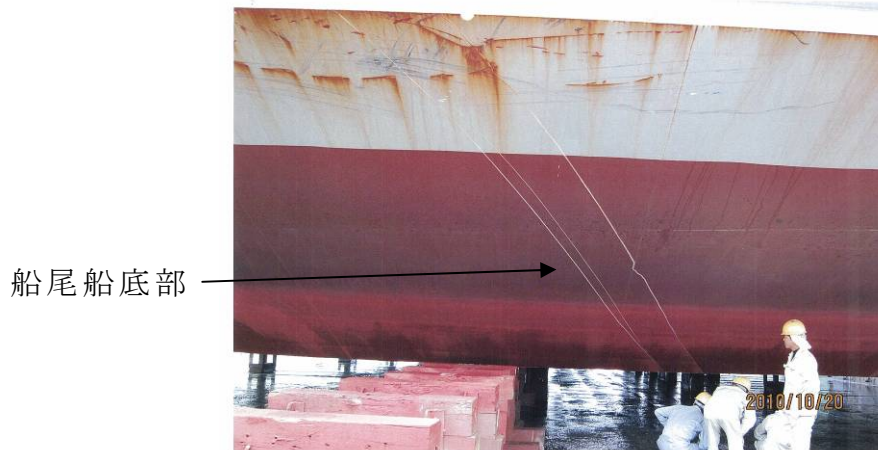
写真7 B船の損傷状況③
