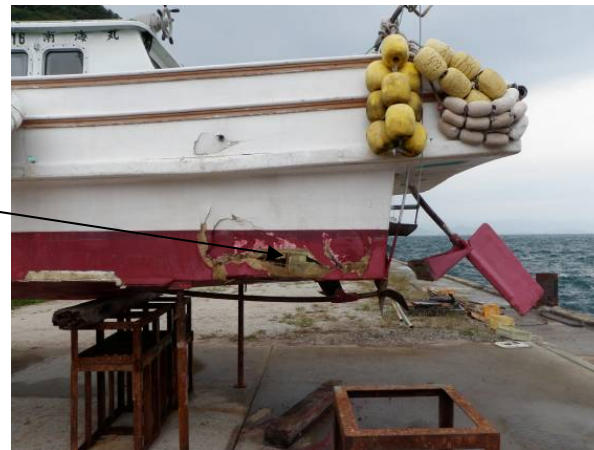
写真 1 1 C 船の損傷状況④
