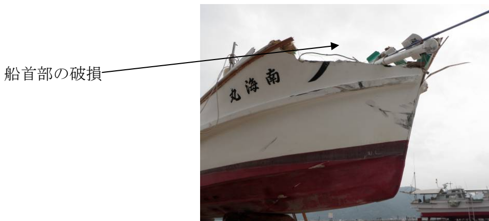
写真9 C船の損傷状況②
