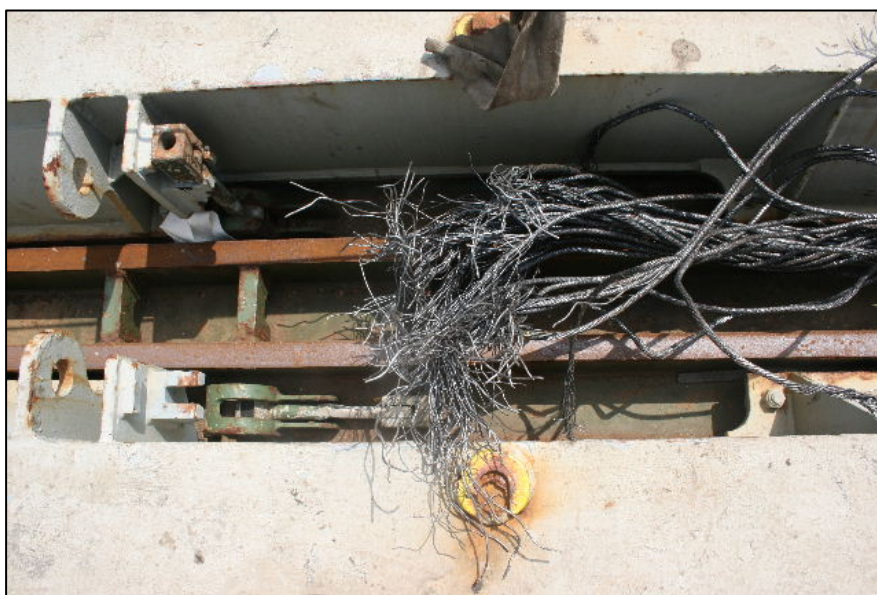
写真6 主ワイヤ破断部
