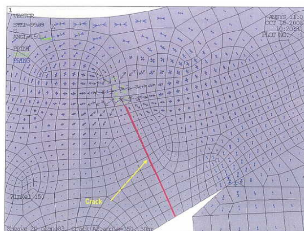
FEM応力分布図（亀裂8mm）
