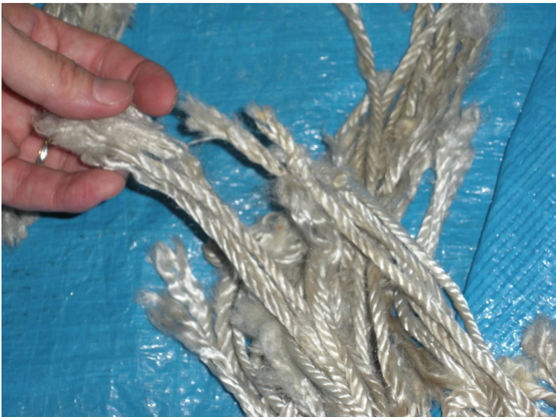
写真4 本件ラインの破断部（ヤーンの状態）
