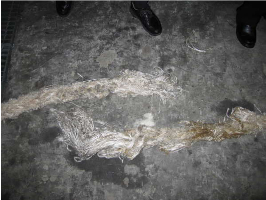
写真4 本件ラインの破断部（ヤーンの状態）
