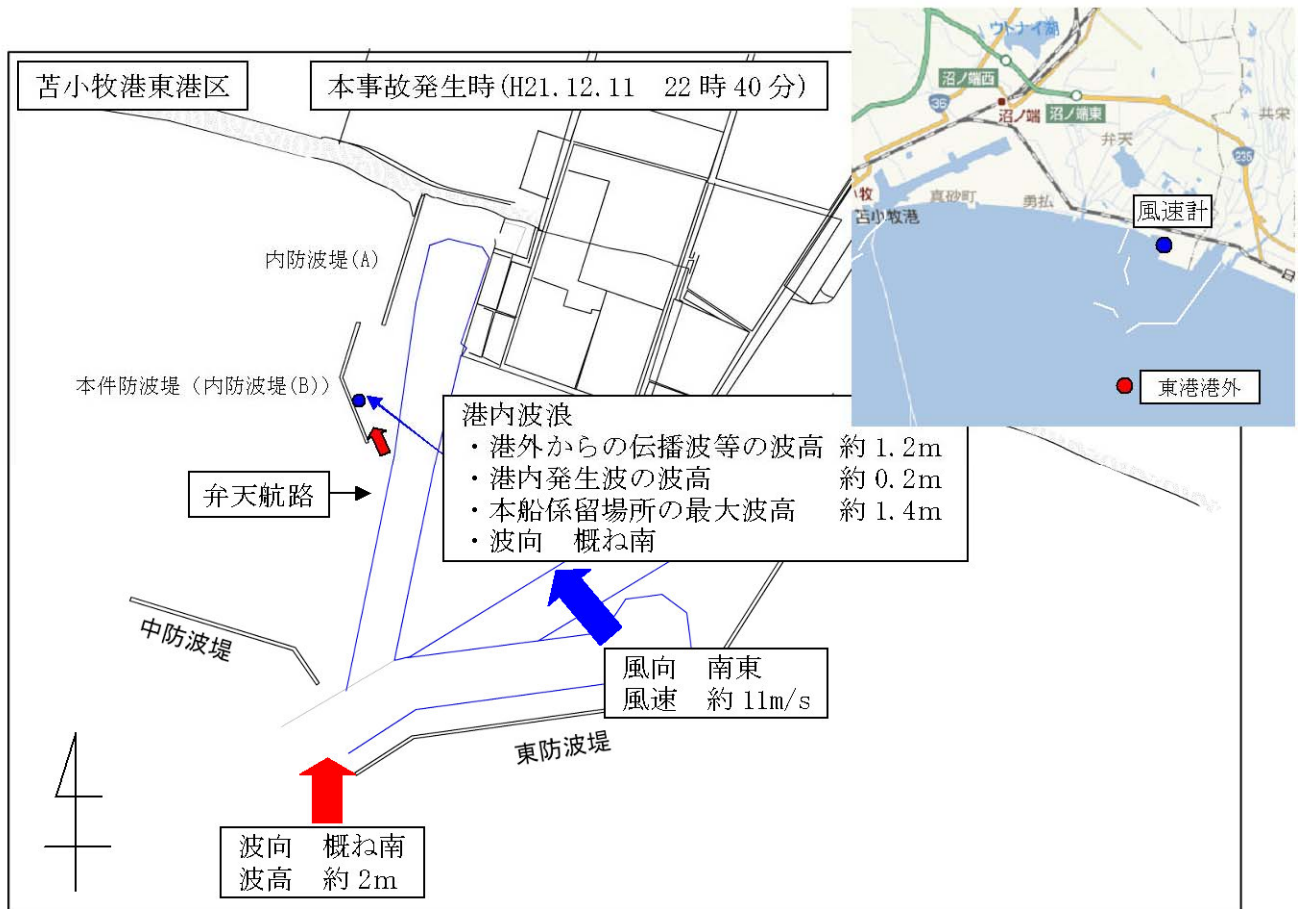
本事故発生時における港内波浪等
