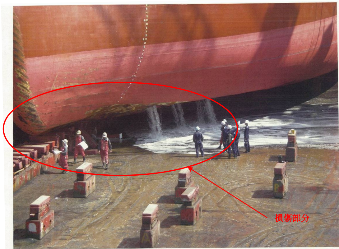
写真3 A船の左舷船首船底
