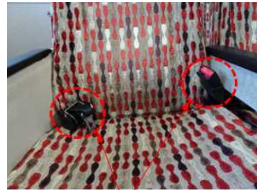
自動巻取式の2点式シートベルト
