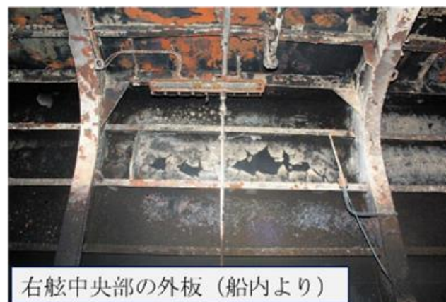
第2甲板右舷中央部の損傷状況
