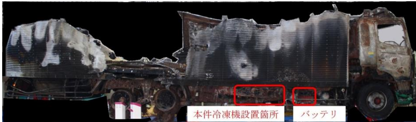
本件車両右側の焼損状況
