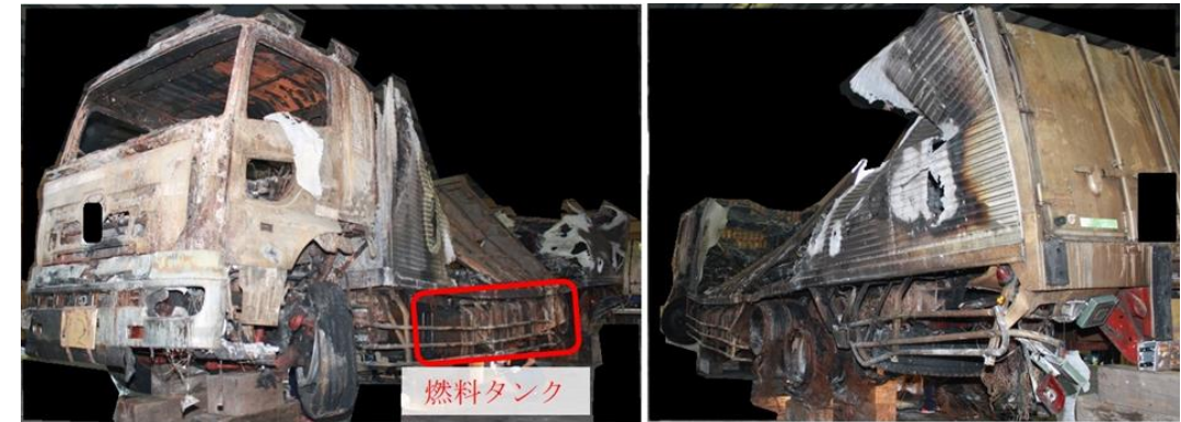
本件車両左側の焼損状況
