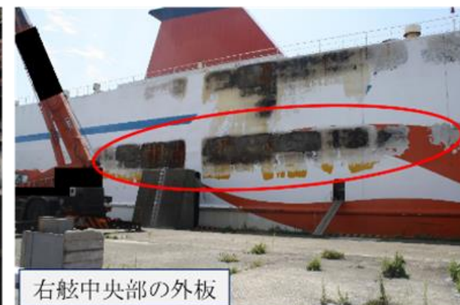
第2甲板右舷中央部の損傷状況
