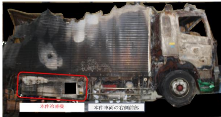
本件冷凍機の設置状況
