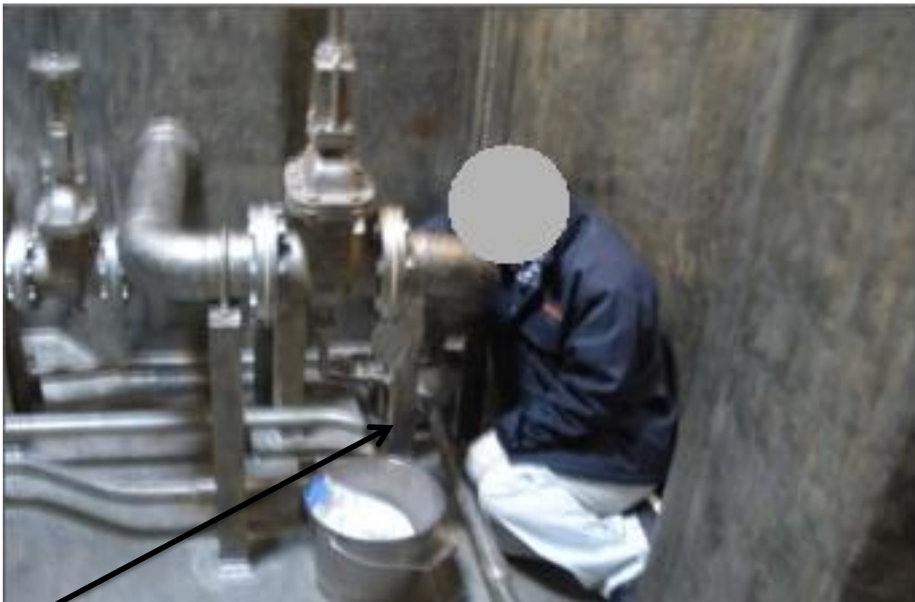
サクシヨンウェル 貨物や洗浄水を効率的に吸引できるよう、貨物タンク内の船尾側に設けた凹んだ区画をいい、貨物や洗浄水の吸引管が設備される。
