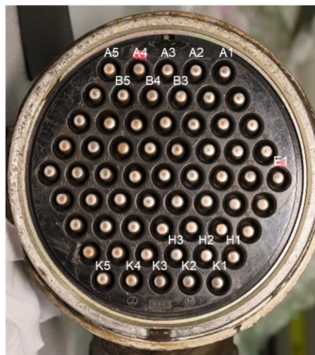
(b) ジャンパー連結器の栓の勘合面
