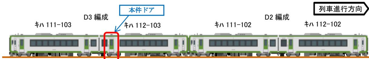
本件列車は、上図の列車編成図に示すようにキハ112-102とキハ111-102から構成される編成（D2編成）と、キハ112-103（本件車両）とキハ111-103から構成される編成（D3編成）を連結した4両編成（以下「D2-D3編成」という。）である。
