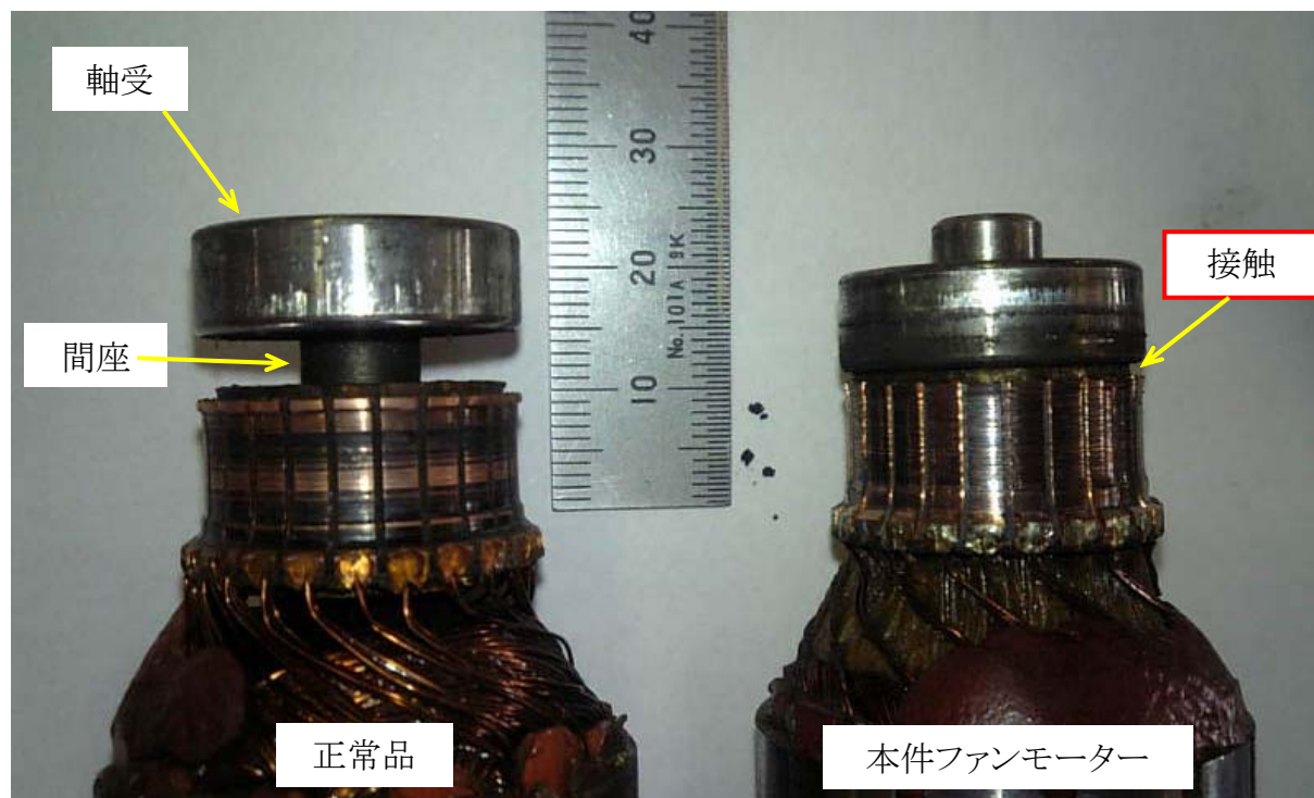
整流子側の軸受の状況
