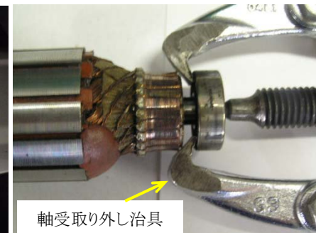
軸受を取り外すときの引き抜く力は 正常品の分解作業時と変わらなかった
