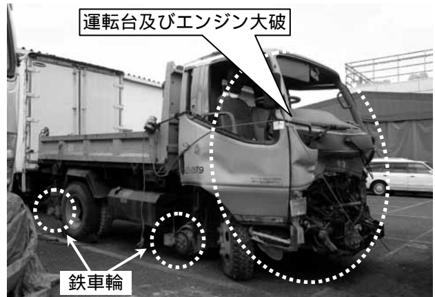
写真4 軌陸車の損傷状況
