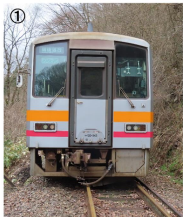
① 前台車の全2軸が右側に脱線
