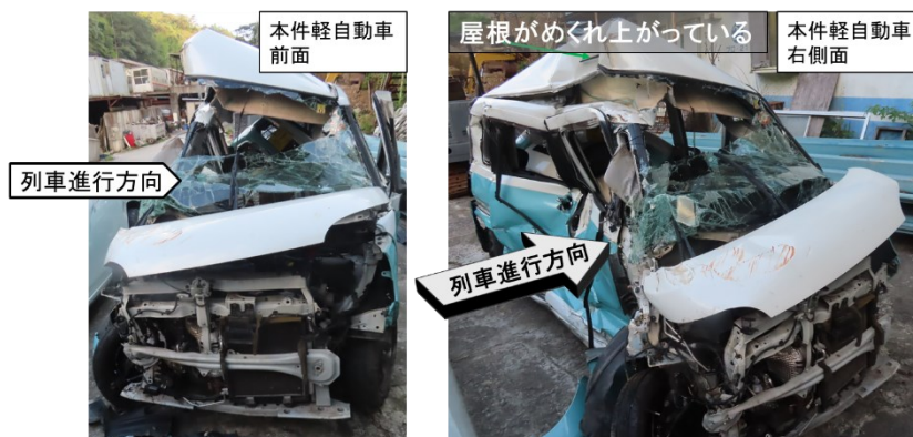
図10 本件軽自動車の損傷状況
