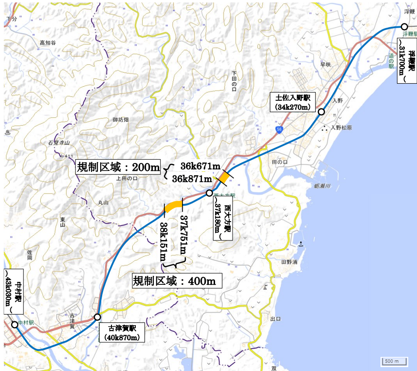
図9 第2次態勢時に徐行を行う規制区域（中村駅から浮鞭駅間）
