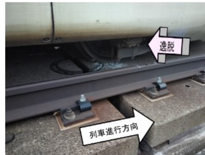
図3 脱線及び逸脱した輪軸例
