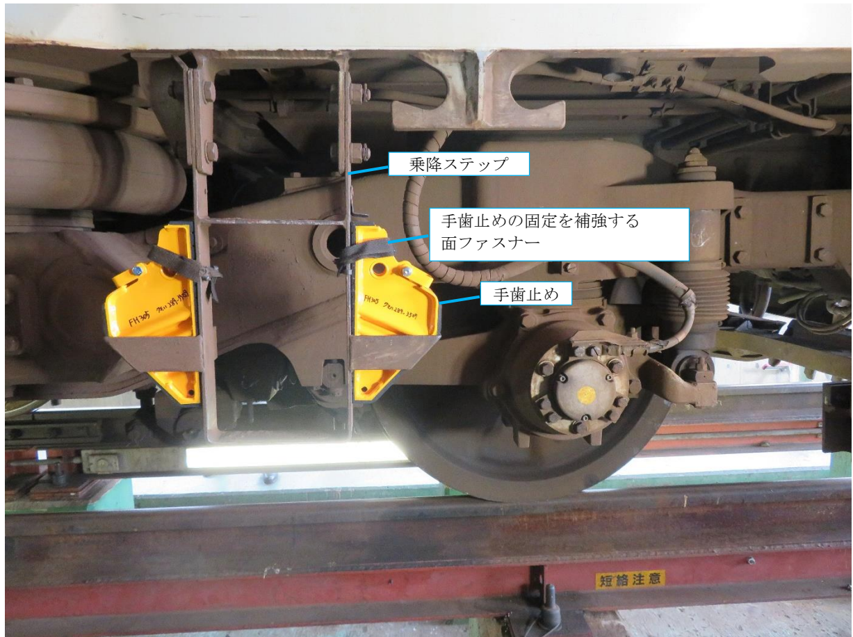
図1 手歯止めの搭載部（正規に搭載した状態。運転台がある車両の前進する方向に対して右側にある乗降ステップに設置）
