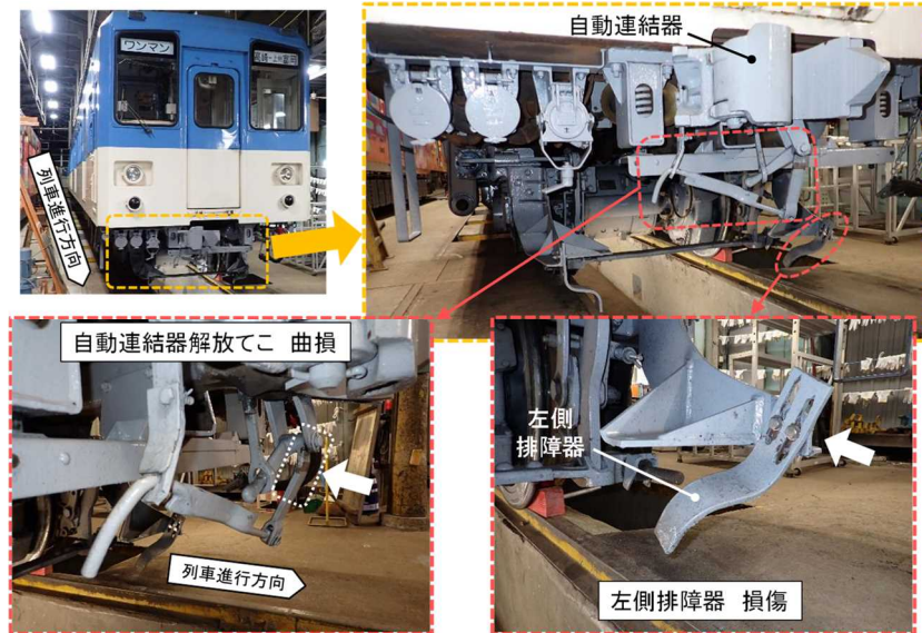
図7 本件車両の主な損傷状況
